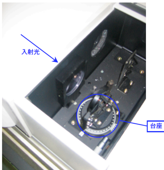
図 A.1：分光光度計の台座。台座は回転板の上に乗っており、入射角を変えることができる。
