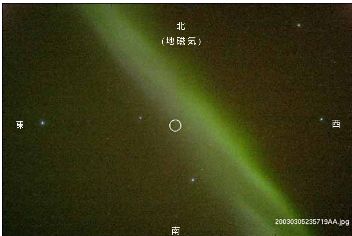
図 3.5 Canon EOS-1D(Canon Lenz 85 mm/F1.2 使用)で撮影された画像。FOV は 19.2 \times 12.8^\circ 。115 km における視野は、 34 \times 26 km である。中心付近の円は、EISCAT UHF レーダーの視野( 0.6^\circ )を示している。
