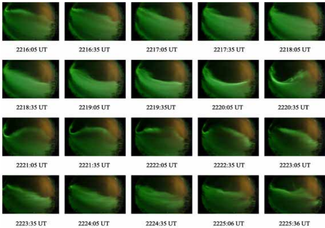
図 4.8 2216 UT から 2225 UT に FinePix S2pro で撮影された全天カメラの画像。低緯度側にディフューズオーロラを伴ったオーロラアークの境界域が低緯度側に移動し、2220 UT 付近で天頂付近まで達した後、高緯度側へ戻るのが見てとれる。
