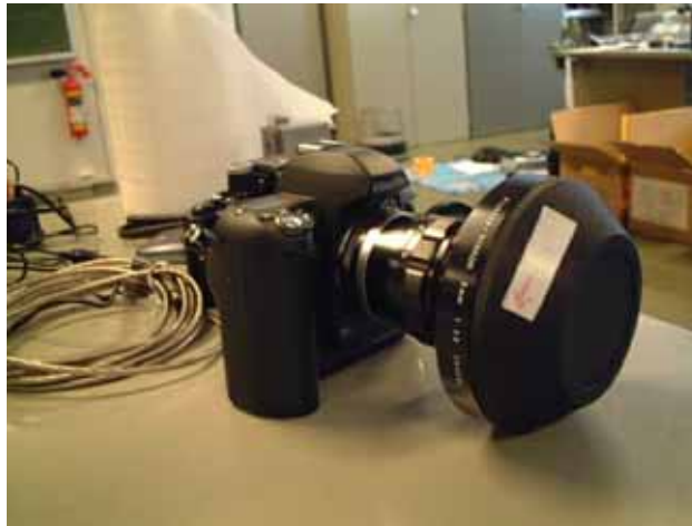
図 3.1 Fujifilm FinePix S2pro の概観。 Nikon Fisheye Lenz 8 mm/F2.8 が付いている状態。
