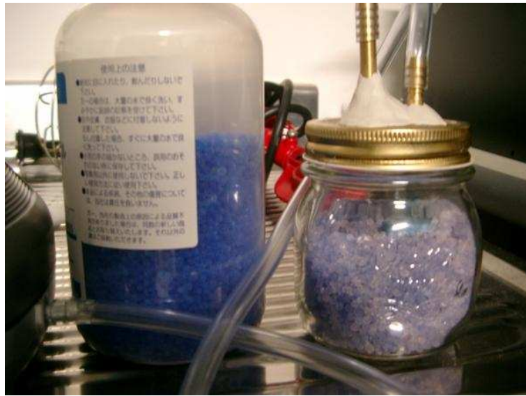
図 3.4: 空気乾燥装置写真 瓶内部に見える青い物質は乾燥剤 (エヌエヌシー ナニワゲル) である
