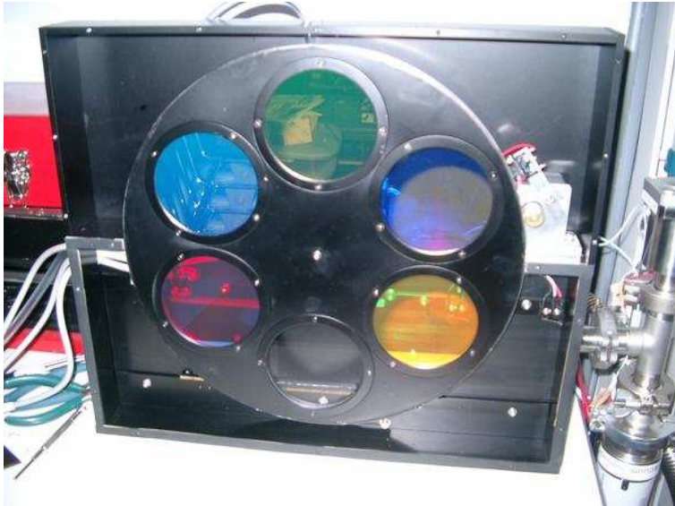
図 2.33: フィルター搭載図 各部分にはまっているフィルターの色は図 2.34 に示す通りである。
