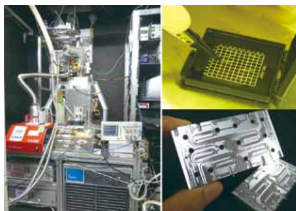
ノルウェーに設置したミリ波ラジオメータの外観(左)。大学院生と共に設計開発を行った超伝導検出素子(右上)および導波管型周波数分配器(右下)
