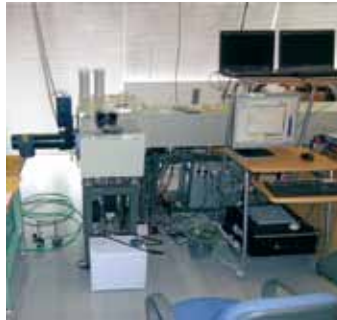
陸別観測所で稼働している高分解能FTIR（国立環境研究所が保有）（左）と観測されたオゾン、水蒸気、二酸化炭素及び四塩化炭素の吸収スペクトル（右）
