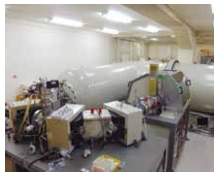
^{14}\text{C} を高精度に測定可能なタンデロン加速器質量分析装置
