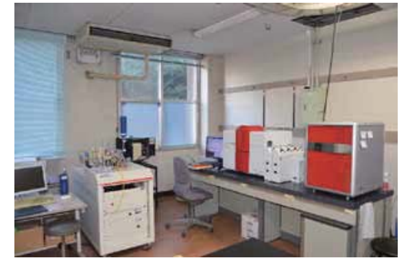
図3. 安定同位体質量分析装置 (左:デュアルインレット方式、右:高温熱分解装置を備えた連続フロー式)
