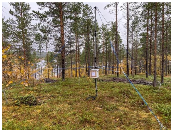
図1 2022年9月9~19日にKevo(フィンランド)に設置したVLF/LF帯雷電波・標準電波観測用ループアンテナ。
