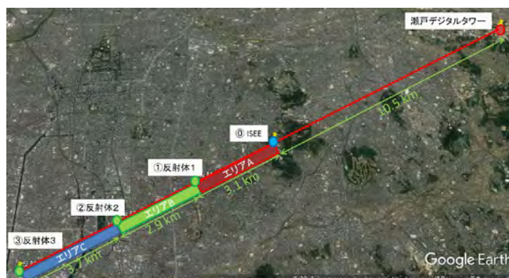
図2: 観測域の位置関係。瀬戸デジタルタワーからの地デジ波を①ISEEで受信。①~③の各反射体からの反射波も同時に①で受信してエリアA~Cの伝搬遅延を測定する。
