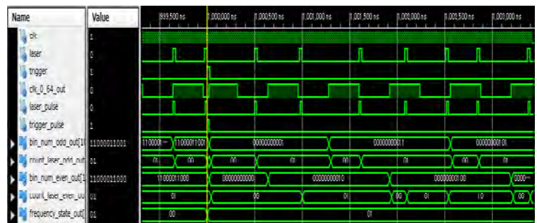
図 1 （上）FPGA を用いたカウンタの構成図 （下）カウンタシミュレーションのテスト画面
