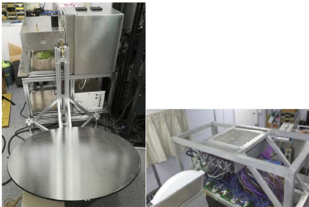
図1 高感度雲観測レーダ（HG-SPIDER）と電子走査雲観測レーダ（ES-SPIDER）
