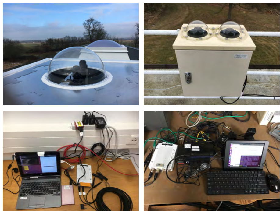
図1: (左) Kühlungsborn に設置した 2チャンネルカメラとコントロール系の写真。(右) Juliusruh のカメラと観測コントロール系の写真。
