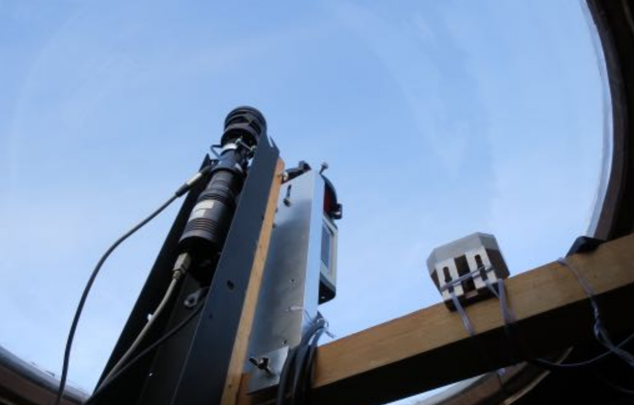
ドーム内にFMIが設置している全天カメラ All sky camera installed inside the dome by FMI
