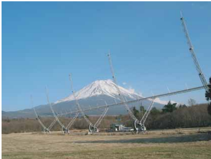
富士山の裾野に設置されている電波望遠鏡。東西長100 m、南北幅20 m のパラボラ反射面を持ち、周波数327 MHz の天体電波の瞬きを観測しています。写真には写っていませんが、東西100 m の間に設置された5本のパラボラの形をした構造体の間に、細いステンレス線が1000本も張られ、巨大な反射面を作っているのです。
