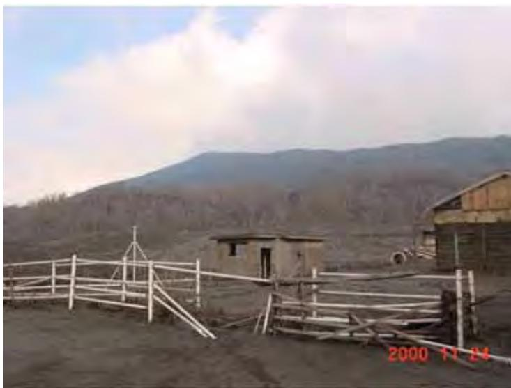
三宅島に設置されたプロトン磁力計（白い三脚）。後方に噴煙を上げる雄山が見える。
