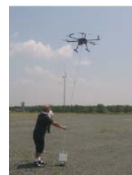
大型ドローンに粒子径分布計測装置を吊り下げた飛行計測。
