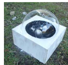
二酸化炭素測の人工衛星の検証のために開発した小型の地上計測装置。
