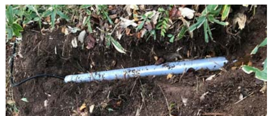
陸別観測所に設置された誘導磁力計の南北センサー。
