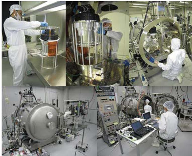
ジオスペース探査衛星「ERG」に搭載される分析器のイオンビームラインを用いた較正試験
