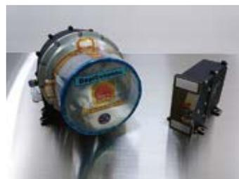
宇宙空間の高エネルギー粒子を観測する探査機搭載用分析器
