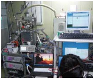
昭和基地で稼働中のミリ波分光計。宇宙からやってくる高エネルギープラズマで引き起こされる超高層大気のおゾンや窒素酸化物の変化を計測します。
