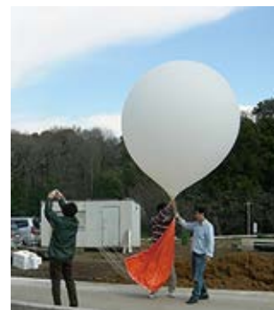
気球 CO 2 ソンデを打ち上げる様子。 Launching of balloon-borne CO 2 sonde.
