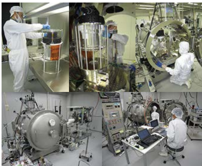
ジオスペース探査衛星「あらせ (ERG)」に搭載された分析器のイオンビームラインを用いた較正試験。 Calibration of plasma particle instruments on "Arase (ERG)" using the beamline in the clean room.
