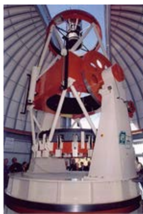
ニュージーランドに設置した MOA II 1.8 m 広視野可視光望遠鏡。 MOA II, a 1.8-m wide-field optical telescope in New Zealand.
