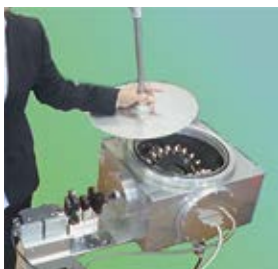
角度分解ネフェロメータ。 Single-particle polar nephelometer.
