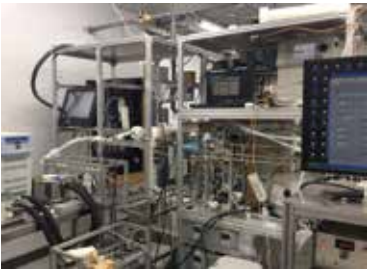
エアロソル粒子の吸湿性を分析するための装置。 Instruments used for analyzing the hygroscopicity of aerosol particles.
