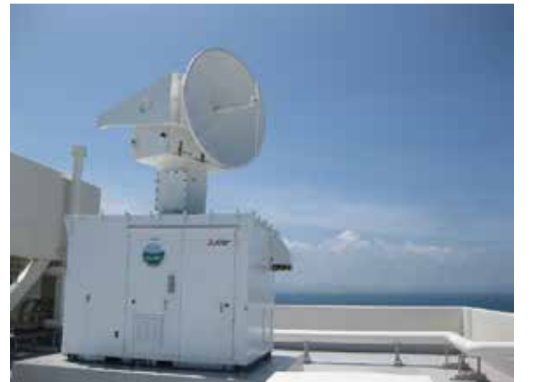
Ka-バンド雲レーダ。 Ka-band cloud radar.
