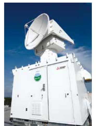
(上) 2013年6月15日にパラオ共和国で放球された雲粒子ゾンデ HYVIS により取得された雲粒子と固体降水粒子の画像 (右) 名古屋大学に設置されている Ka バンド雲レーダ
