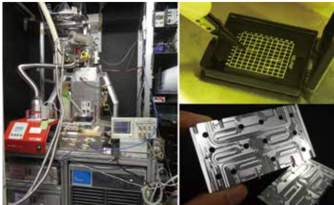
ノルウェーに設置したミリ波ラジオメータの外観（左）。大学院生と共に設計開発を行った超伝導検出素子（右上）および導波管型周波数分配器（右下）
