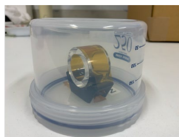
図 1 Na セルに用いる端面が高精度研磨されサファイアボディ。
