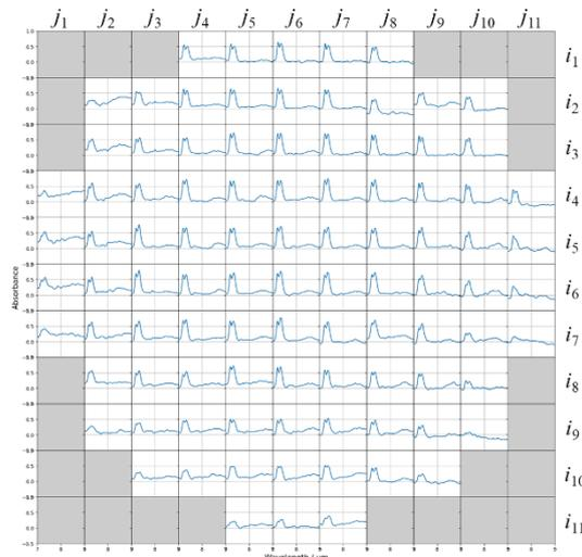
図 2 真空チャンバー内に SO<sub>2</sub> ガスをパルス噴出してからの透過吸収イメージングスペクトルの経時変化。1 グリッドは 360×360 μm の範囲を平均化して表示している。灰色でマスクされているグリッドは、その中心がサンプルホルダー中心の直径 3 mm の貫通穴の円周よりも外側にあるエリアである。
