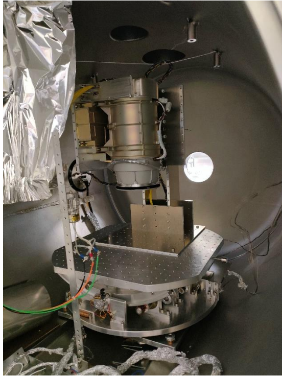
写真1：真空槽にセットしたMSAフライトスペア
