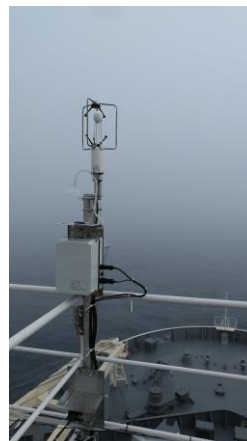
図1 しらせの第1甲板中央船首側に設置した乱流フラックス観測システム
