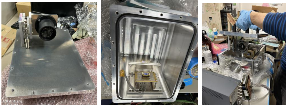
図1. (左) 紫外カメラチャンバ蓋部にとりつけられた遠紫外用 CaF 2 レンズ。角度調整機構をつけてある。(中) 紫外チャンバ内に取り付けられた CCD 固定治具と CCD 検出器、(右) 紫外カメラチャンバ組み上げ作業中の状況。手前にあるのが民生品カメラヘッドで、これにケーブル・コネクタを嵌合させることで正常動作を確認した。
