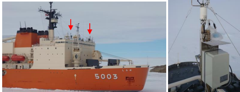
図1 しらせの第1甲板船首側に設置した乱流フラックス観測システム
