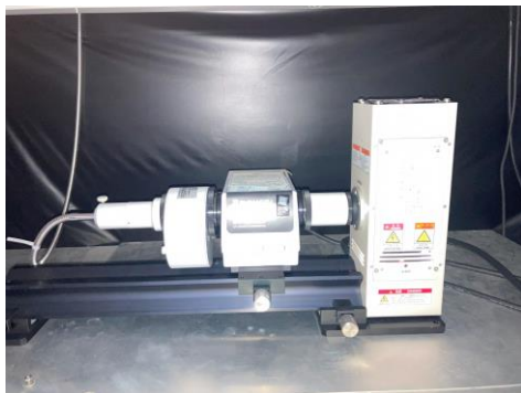
キセノンランプと分光器を組み合わせた光源。遠隔操作により自動測定ができるようになっている。
