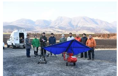
図3 Pixhawkを搭載し大気中水銀観測を実施したカイトプレーン（右）と超微小粒子観測を実施したマルチコプタ（左） 2025年3月9日16時半。久住連山が野焼きのエアロゾルにより霞んでいる。
