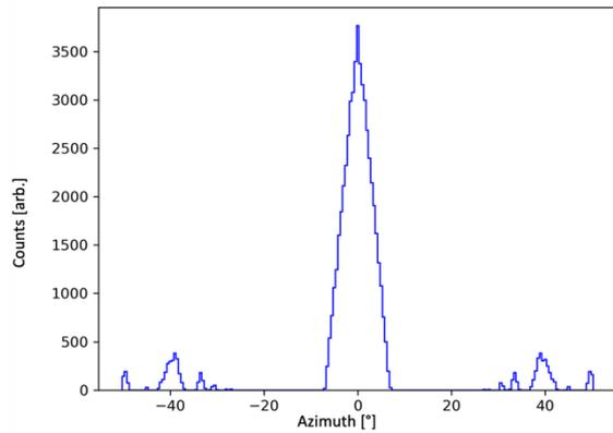
図 4. レイトレーシングシミュレーションで得られたコリメータの角度応答特性.
