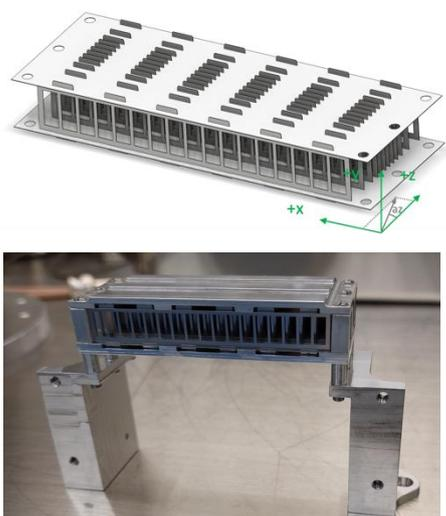
図 1. (上) 機械式粒子コリメータの CAD モデルと (下) そのプロトタイプモデル
