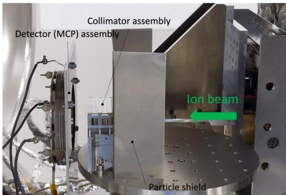
図 5. イオンビームライン真空槽中のターンテーブル上に設置された粒子コリメータ。ターンテーブルを回転させコリメータのイオンビームに対する角度を変化させる。
