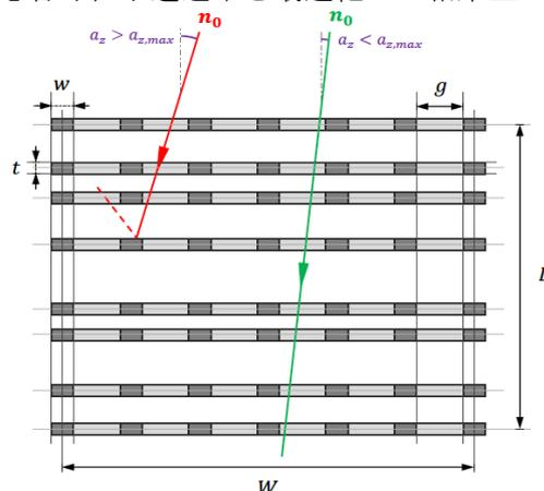
図 2. 機械式粒子コリメータの断面図。(緑線) 通過粒子の軌道, (赤線) 遮断される粒子の軌道 (Maynadie, Master thesis, 2023).
