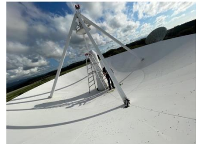
図 2 : 10m アンテナ鏡面でのシステム性能評価の様子
