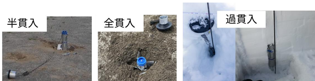
図2：投下実験後の分離の様子
