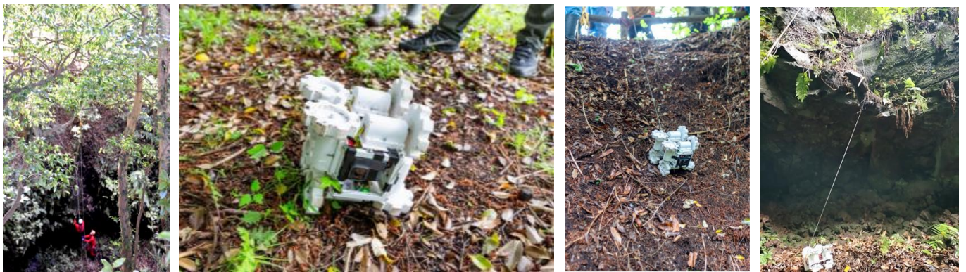
図 3. 「穴の原溶岩洞穴」実験（中右、右：UGV の懸垂下降）
