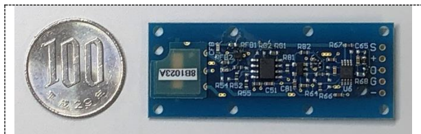
図2: 磁気インピーダンスセンサーの外観。これで磁場の1軸を計測できるので、磁力計にするには3つを組み合わせる必要がある。
