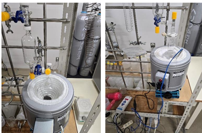
図1. マントルヒーターによる試料加熱の様子。 (左) 石英ウール・温度制御コントローラーなし。 (右) 石英ウール・温度制御コントローラーあり。
