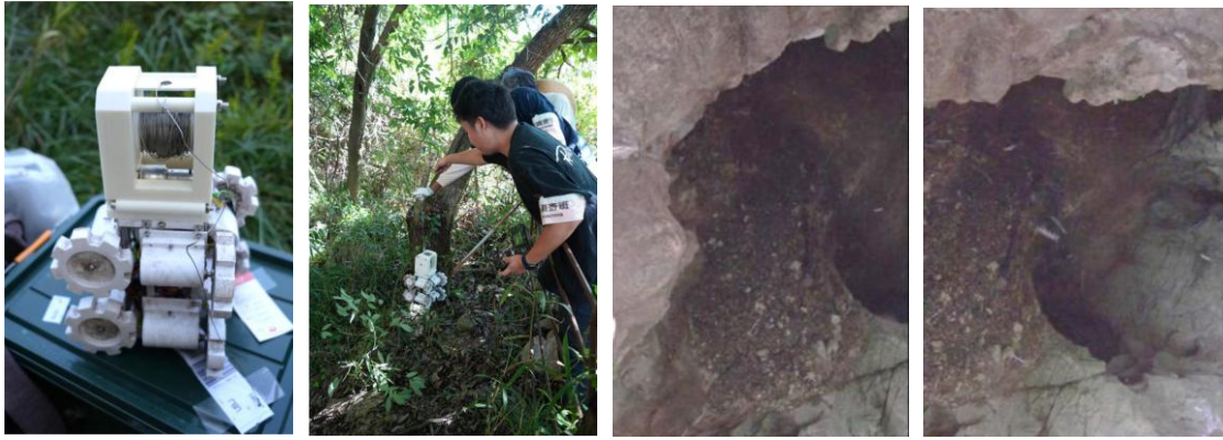
図 2. 「無名穴」実験（中右、右：UGV カメラによる縦穴底の画像）
