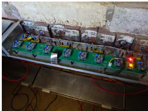
図 2 新型フロントエンド回路は、既存のミュオン検出器に設置され試験運用されている。
