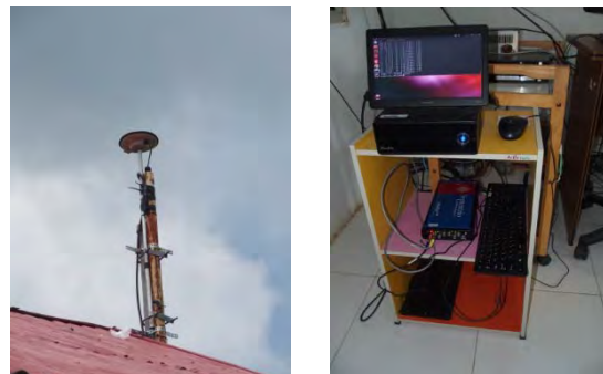
図 2. インドネシア・コタバンに設置した 3 周波 GNSS アンテナ(左)と受信システム(右)。
