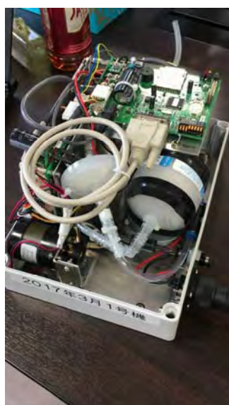
写真1：（左）シースプレー測器の内部，（中央）観測塔に設置した状態，（右）測器を設置した観測塔全景（赤丸は測器設置箇所を示す）
