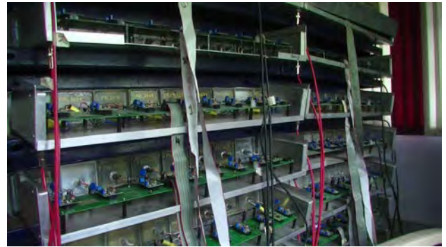
図2 ストレージルームに置かれた比例計数管に新型フロントエンド回路が取り付けられ、試験が行われている。
