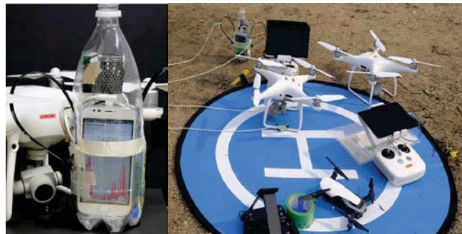
図2. 測定装置を封入したカプセルとドローン
