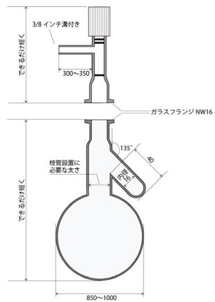
図2 新しく開発した反応容器
