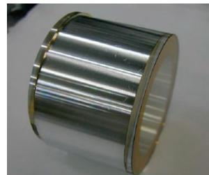
図3 試作したNaセル。ボディがアルミニウムで窓がサファイア。
