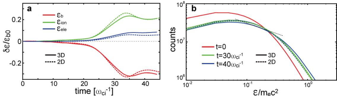
図1：Nakamura et al. [2019]（参考文献1）で行った粒子シミュレーションの粒子データ解析結果。シミュレーション領域内の(a)磁場、電子粒子、イオン電子の全エネルギーの時間変化、及び、(b) 電子のエネルギースペクトルの時間発展。磁気リコネクションの成長と共に、磁場のエネルギーが解放され、電子とイオンの運動エネルギーに変換される。3次元計算の場合にのみ、ジェット先端領域におけるLHDIの成長と共に電子が負荷的に加熱される。この付加的な加熱は比熱的電子の生成を伴う。
