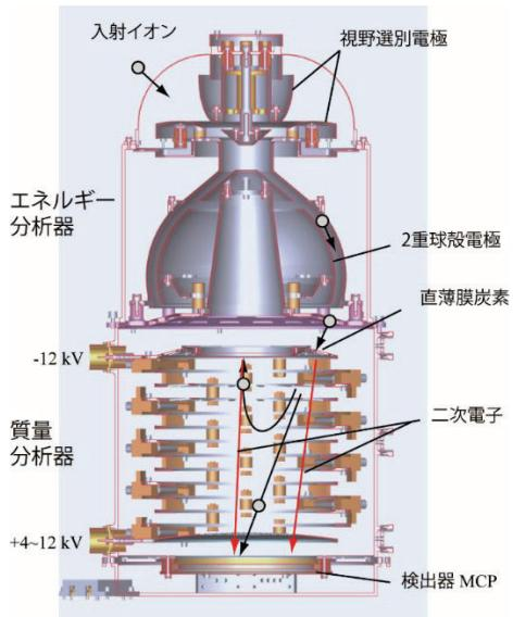
図 1：イオン分析器 CAD モデル断面図
