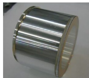
図3 試作したNaセル。ボディがアルミニウムで窓がサファイア。
