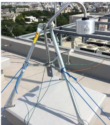
図 1 フィールドミルの概観
