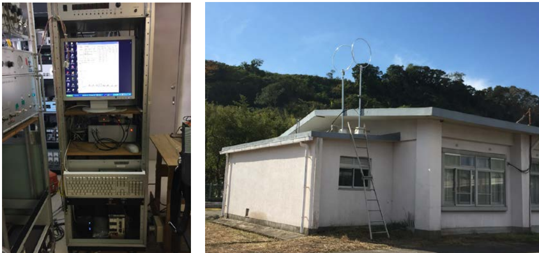
図 1 : 鹿児島観測所に設置された LF 帯標準電波観測装置(2016/12/17-19 設置)
