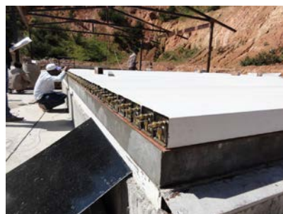
Figure 1 比例計数管の屋外への設置作業（2016 年 12 月現在）。
