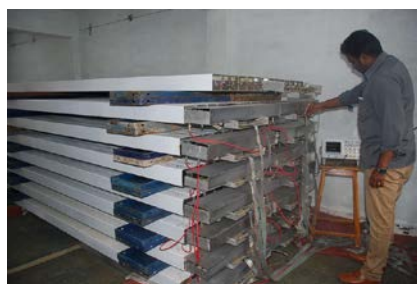
Figure 2 比例計数管およびフロントエンド回路の性能試験 (8 Layer = 8 fold)。
