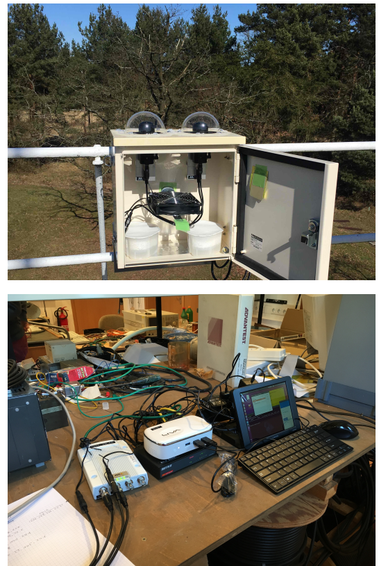
図1: (上) Juliusruh 観測所建物の屋上に設置した2波長大気光カメラと (下) 観測コントロール系の写真。
