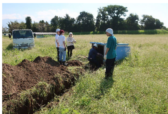
図1 鹿児島観測所でフラックスゲート磁力計を設置している図
