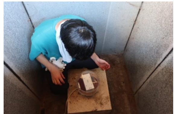
図1 磁力計センサの設置(鹿児島観測所)
