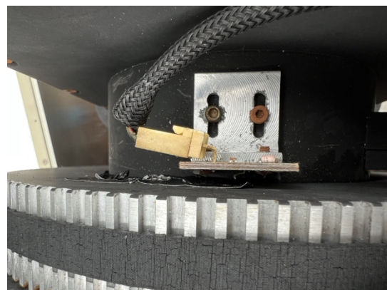
図 3 FPI のセンサ部分
