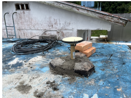
図 1 観測施設の屋根に取り付けた GPS 受信機
