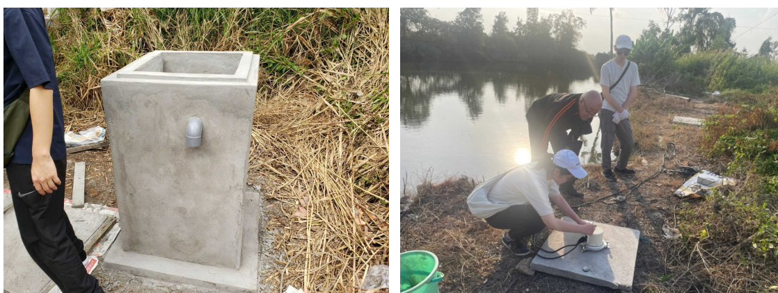
図 3 新センサーハット(左)、磁力計仮設置の様子(右)
