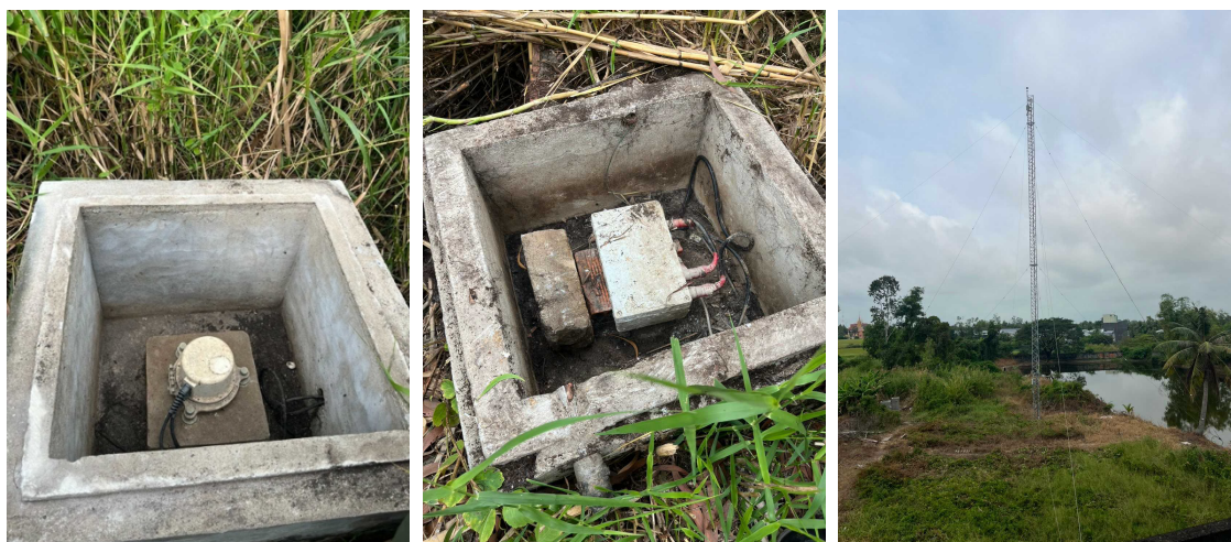
図 2 旧 flux 磁力計センサー(左)、アンプ(中央)、FMCW レーダー(右)
