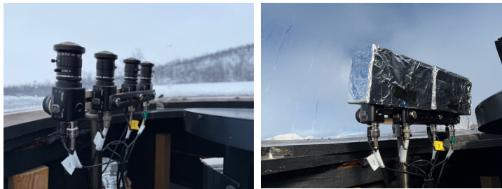
図 3 キルピスヤルビに設置されている全天カメラ群と自作したカバーを設置した様子
