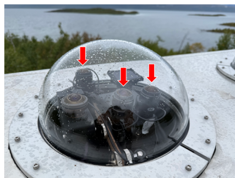
図3 設置した427.8 nm、557.7 nm、630.0 nm 観測用カメラ
