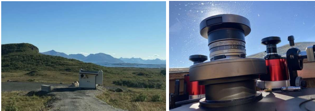
図 Stø 観測点とドーム内の全天カメラ。視野に移りこまないような高さ調節が困難。
