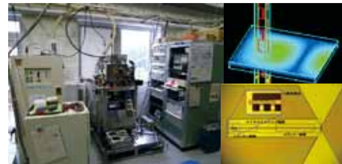
北海道の陸別観測所に設置されたミリ波分光計(左)、電磁界解析による導波管回路の電波伝搬の計算(右上)、超伝導SIS素子中心部の顕微鏡写真(右下)
