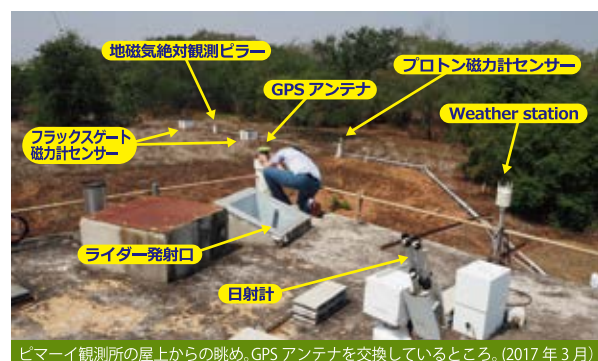
ピマーン観測所の屋上からの眺め。GPSアンテナを交換しているところ。(2017年3月)
