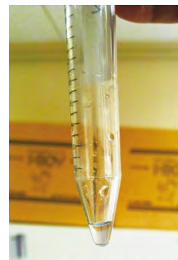
試料から抽出したベリリウム10を含む水酸化ベリリウムの沈殿
