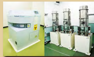
原医研にある放射線照射装置： 左が高線量照射のできるガンマセル 右が低線量率照射装置
