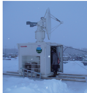
北海道東部陸別町でのマルチパラメータレーダーによる降雪の観測。
