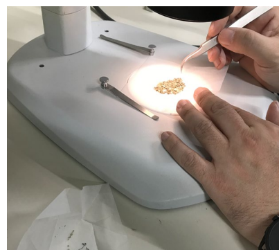
粉碎した岩石から実体顕微鏡下でカンラン石を分取。
