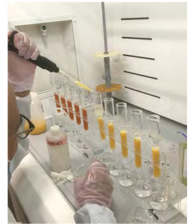
Be フラクション抽出のための岩石試料のカラム分離の様子。
