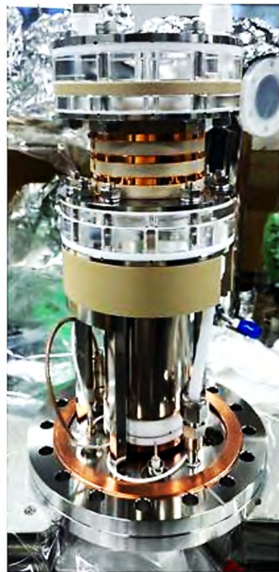
密閉石英容器を内包した0.1L液体キセノン TPC プロトタイプ検出器。
