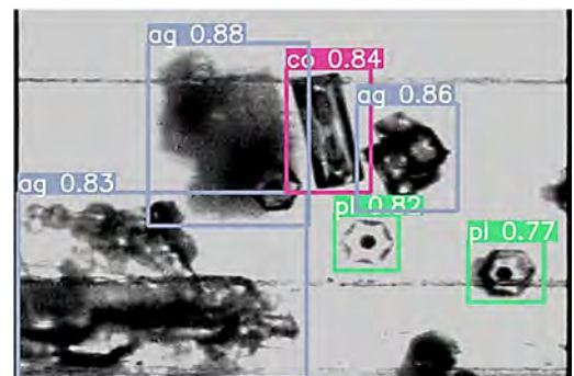
雲粒子ゾンデで観測された固体雲粒子を深層学習により客観的判別を行った例。四角で囲まれている粒子が判別された粒子で、aqは凝集粒子、coは角柱状粒子、plは板状粒子である。
