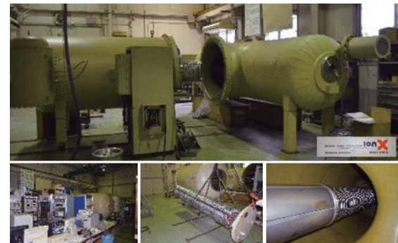
数多くの ^{14}\text{C} 論文を生み出したタンデロン加速器質量分析計 1 号機 (老朽化のため 2021 年 5 月に廃棄)
