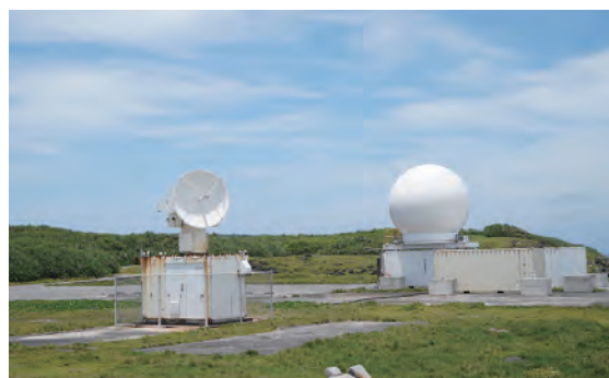
夏季に沖縄県与那国島で米国と共同で実施したレーダ観測の様子。左側が名大 Ka 帯レーダ
