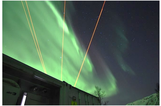
ノルウェー・トロムソに設置されたライダー・コンテナ上空で、2025 年 2 月 28 日に撮影されたオーロラ。オレンジ色の線がライダーから射出されたレーザービーム（波長 589 nm）。
