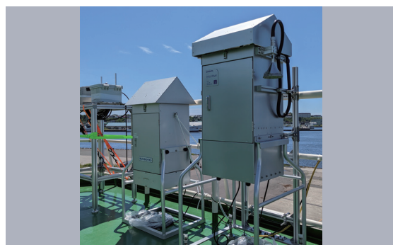
船舶(新青丸)に設置した洋上エアロゾルサンプリング観測装置
