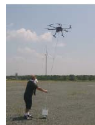
大型ドローンに粒子径分布計測装置を吊り下げての飛行計測。
