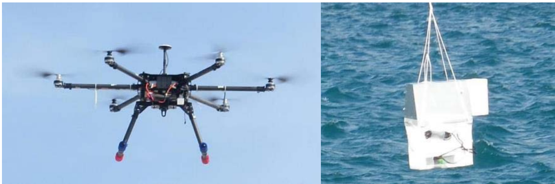
波しぶきの観測の様子。左図は観測に用いたドローンの飛行の様子。右図はドローンで海上に吊り下げた雲粒子ゾンデ。
